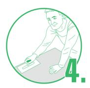
CaSi-Systems Wohnklimaplatten-Kleber 3in1 im angegebenen Mischungsverhältnis anrühren und mit einem Zahnspachtel vollfl ächig auf die Wand auftragen. Bei ebenen Untergründen kann der CaSi-Systems Wohnklimaplatten-Kleber 3in1 direkt auf die zu verarbeitenden Wohnklimaplatten aufgetragen werden.
