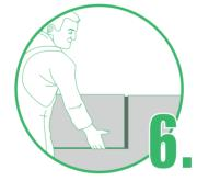
...mit gleichmäßigem Druck an den Untergrund andrücken und einschwimmen. Die Platten werden stumpf und ohne Kleber in die Stoß- und Lagerfugen gestoßen.
