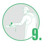
Anschließend die gesamte Fläche abspachteln und glätten. Nach der Trocknungszeit können Sie mit der diffusionsoffenen Oberflächengestaltung, z.B. mit einer Silikatinnenfarbe, beginnen.
